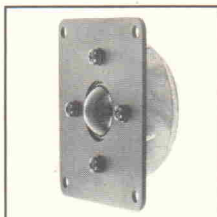
DTW 95 FFL: Spitzen-Kalotten-Hochtöner mit Ferrofluid, hervorragendes Impuls- und Dynamikverhalten, 110/150 Watt bei 12 dB-Weiche ab 5.000 Hz, 12.000 - 30.000 Hz, 4 + 8 Ohm, 95 x 95 mm
