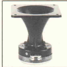
HTH 5.15: Druckkammer-Hochtönerhorn mit sehr hohem Schalldruck und hoher Belastbarkeit, 80/100 Watt, 2.000 - 15.000 Hz, 8 Ohm, 110 x 110 mm
